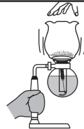
下ボールにコーヒーが下がったら片手でしっかりとスタンドを持ち、上ボールを前後に傾けるようにして静かに外します。
