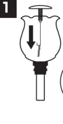
ろか器を上ボールの中心に入れて鎖を引き、必ずフックを足管の先端に引っ掛けて固定します。
