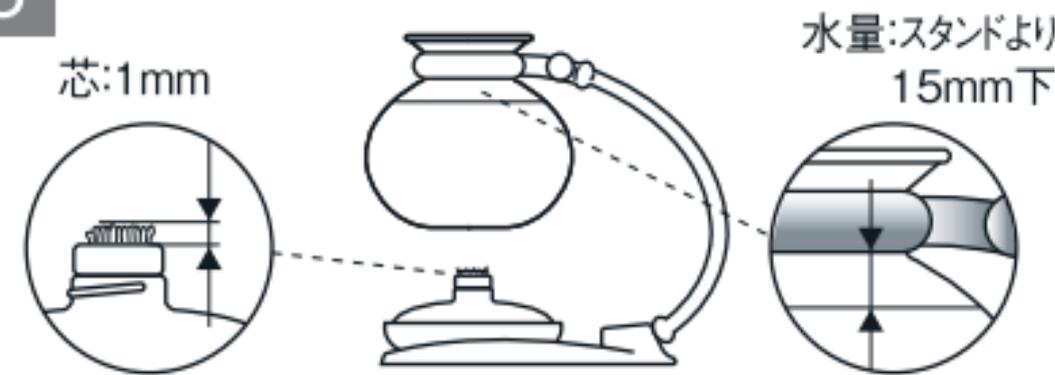
一杯分(130~140mL)のお湯または水を下ボールに注ぎます。スタンドの約15mm下が水量の目安です。上ボールを差し込みます。圧力調節穴が水面に隠れていないことを確認してください。隠れている場合は水量を減らしてください。綿芯は火口より1mm程度にしてください。
