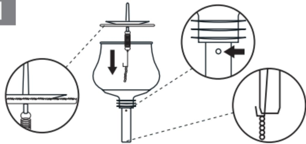
ろか布は起毛面を上にしてろか器にセットします。ろか器を上ボールに入れて鎖を引き、フックを足管の先端に引っ掛けて固定します。ゴムパッキンの下に小さな穴(圧力調整穴)が見えることを確認してください。
