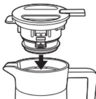
中せんを真下に押し込んでください。カチツと音がするまで確実に押し込んでください。中せんが確実にセットされてないと、飲み物が漏れるおそれがあります。
