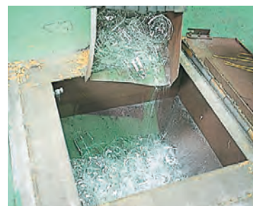
製品化されなかったガラスは集められて粉碎し、リサイクルします。
