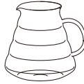
2. XGS-80 ガラスサーバー 耐熱ガラス 耐熱温度差120℃ XGS-80 glass server Heatproof glass (Heat resistance temperature difference : 120℃)
