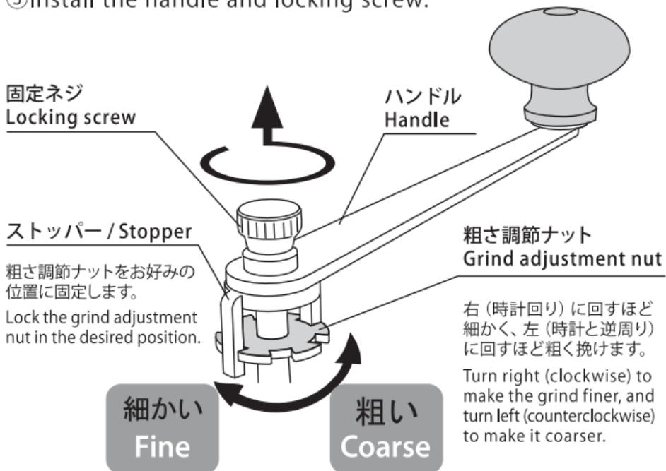
⚠ 粗さ調節ナットを時計回りに回転しすぎると、臼同士が接触して臼を傷め、故障の原因になることがあります。
