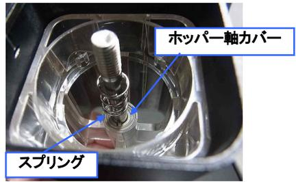
③ 内臼に固定ピンをセットし、下からホッパーに外臼、シャフトに固定ピンをセットした内臼を取り付け、最後に粗さ調節ツマミを取り付けます。
