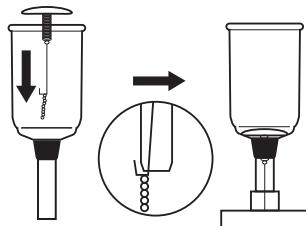
ろか器を上ボールの中心に入れて鎖を引き、必ずフックを足管の先端に引っ掛けで固定し、フタ兼上ボール立てに差します。
