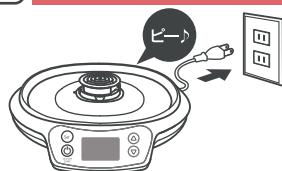
電源プレートの切り込みにコードを通してコンセントに差し込んでください。
