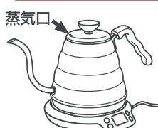
蒸気口が注ぎ口側になるようにフタをセットしてください。蒸気口からは高温の蒸気が出ます。ハンドル側にセットすると、注ぐ際にやけどをする恐れがあります。
