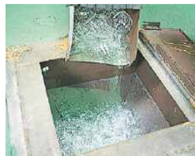
製品化されなかったガラスは集められて粉砕し、リサイクルします。
